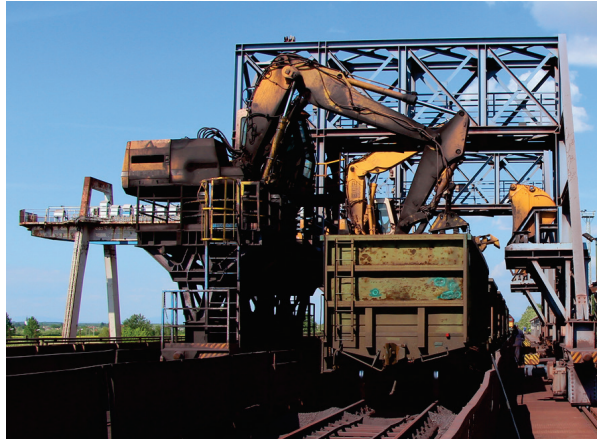
6.4. ábra. Vagonürítő berendezés (vibrátor), forrás: Döbrentei Balázs
