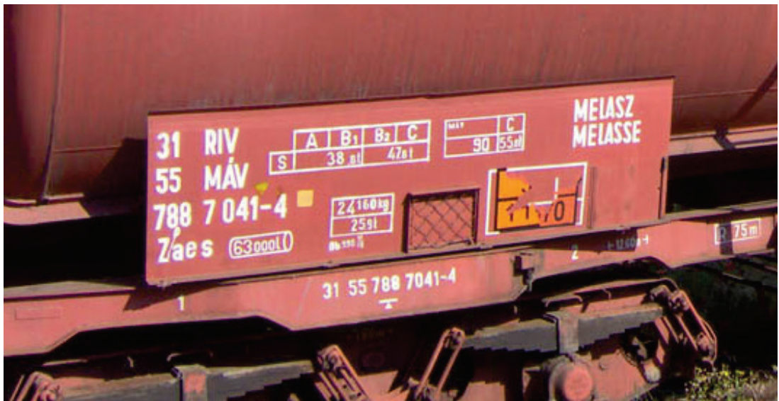
1.28. ábra. Teherkocsi űrtartalma (jobbra) és engedélyezett töltőanyaga (balra) forrás: Vasúti kocsik számozása, jelei és felirata (fent), Gyenes Viktor (lent)
