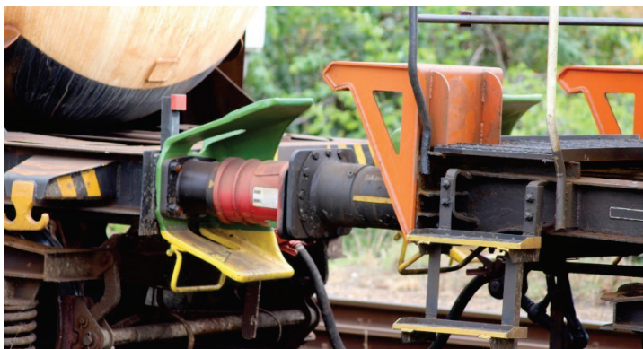
1.19. ábra. Kétféle felszerelt ütközőfelugrás elleni védőeszköz, forrás: www.forum.index.hu
