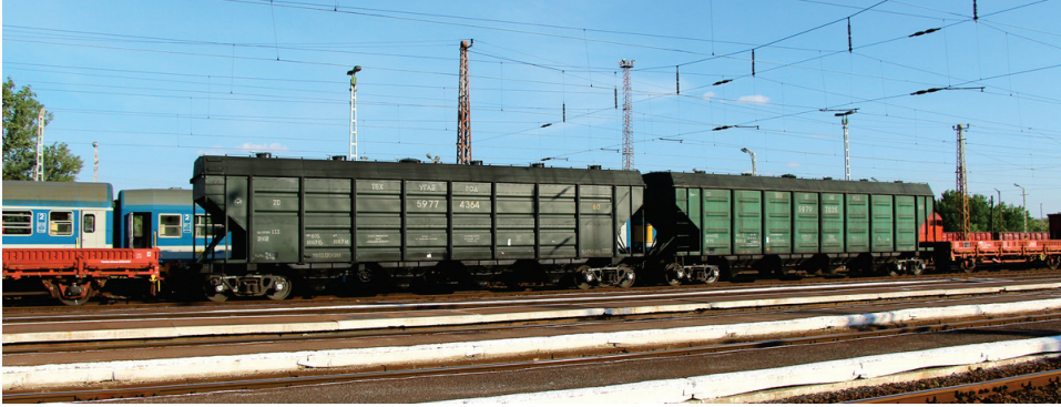
6.7. ábra. A két tengelyátszerelt kocsi mindkét végén egy-egy közvetítőkocsi forrás: Döbrentei Balázs
