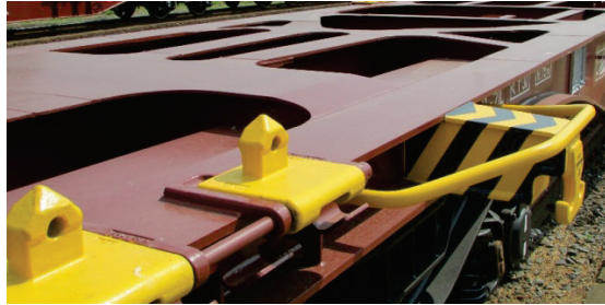
1.22. ábra. Felhajtott tüskék egy konténerszállító vasúti kocsin, forrás: www.innorail.hu
