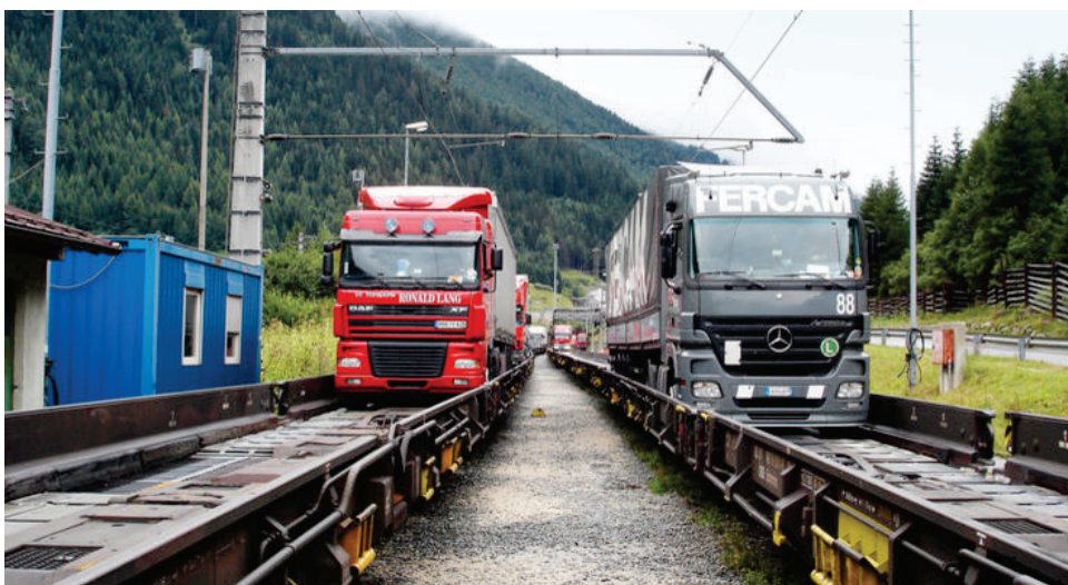
1.24. ábra. Speciális RoLa teherkocsik használat közben, forrás: www.eurotransport.de
