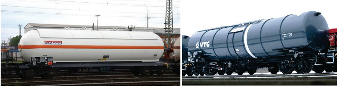
1.29. ábra. Gázos (balra) és ásványolajos (jobbra) tartálykocsi forrás: Anton Kendall (balra), www.vtg.de (jobbra)
